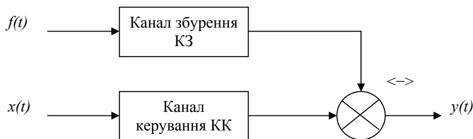
Рис. 1.1. Структурна схема об'єкта керування
